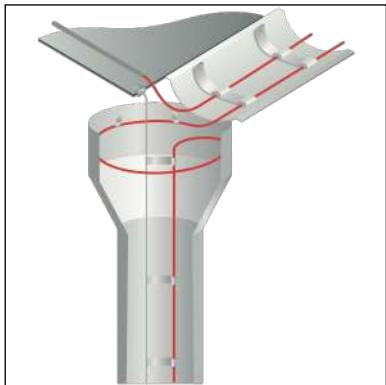
возможно попадание листьев, иголок, мусора и т.п. в водосточную систему и забивание водосточных труб. При установке в вертикальные трубы большой мощности (50-60 Вт/м) возможен перегрев и выход из строя кабеля в месте накопления мусора. Настоятельно рекомендуется обращать внимание на эту проблему и проводить очистку водостоков перед включением кабельной системы в осенне время. Рекомендуется также установить защитную сетку на входе в воронку водосточной трубы.
